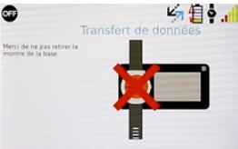
L'exécution des procédures peut prendre quelques minutes. Vous serez tenu informé de la progression sur l'écran tactile. Ne retirez pas la Mediawatch de la Dockingstation pendant qu'elle charge. L'écran tactile se met en veille automatiquement après 30 secondes d'inactivité. Appuyez sur l'écran tactile pour le réactiver.
