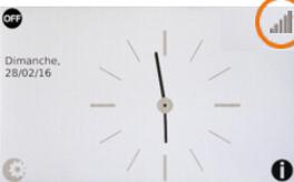
La Dockingstation va maintenant être automatiquement connectée à la centrale GfK. Cela peut prendre quelques minutes. Vous pouvez voir en haut à droite, dans le menu principal, un symbole représentant la puissance du signal de la liaison radio. Tant que toutes **les barres sont grises**, l'appareil n'est pas connecté à la centrale.
