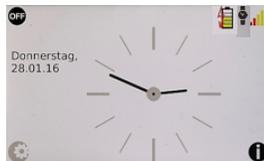
Sobald alle Prozeduren abgeschlossen sind, wird das Hauptmenü auf dem Touch-Display angezeigt. Im Hauptmenü sehen Sie in der Mitte die aktuelle Zeit sowie das aktuelle Datum. In der rechten, oberen Ecke sind die Statusanzeigen eingebildet. In den restlichen Ecken sehen Sie die Bedienungstasten, welche Sie mit dem Finger antippen können.
