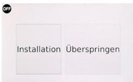
Nach wenigen Sekunden startet die Dockingstation und das GfK-Logo erscheint auf dem Display. Das Aufstarten der Dockingstation kann bis zu einer Minute lang dauern, bis auf dem Display folgende Anzeige erscheint. Diese wird nach 5 Sekunden wieder ausgeblendet und das Hauptmenü wird angezeigt. **Bitte drücken Sie während diesen 5 Sekunden nicht auf das Touch-Display.**
