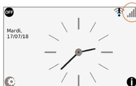
La Dockingstation se connecte automatiquement à la centrale GfK. Cela peut prendre quelques minutes. Dans le menu principal, vous pouvez voir l'intensité du signal de la connexion radio dans le coin supérieur droit. Si **toutes les barres sont grises**, l'appareil n'est pas connecté à la centrale.
