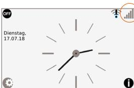
Die Dockingstation verbindet sich automatisch mit der GfK-Zentrale. Dies kann einige Minuten dauern. Im Hauptmenü sehen Sie in der rechten, oberen Ecke die Signalstärke der Funkverbindung. **Sind alle Balken grau, besteht keine Verbindung** zur Zentrale.
