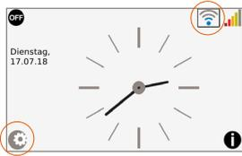
**Alternativ** kann die Dockingstation auch mit Ihrem WiFi verbunden werden, indem Sie die Einstellungstaste drücken (unten links) und zuunterst im Einstellungs-menü die Konfiguration öffnen. Bei erfolgreicher Konfiguration ist das WiFi-Symbol umrandet.
