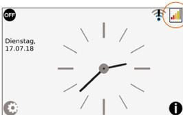
**Farbige Balken zeigen die erfolgreiche Verbindung an. Der Anschluss der Dockingstation ist somit erfolgreich beendet.** In der rechten, oberen Ecke sind die Statusanzeigen eingeblendet. In den anderen 3 Ecken sehen Sie die Bedienungstasten, welche Sie mit dem Finger antippen können.
